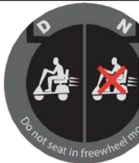
Posizionare l'unità su un terreno piano quando si passa dalla modalità di guida "D" alla modalità a ruota libera "N" o dalla modalità a ruota libera.
